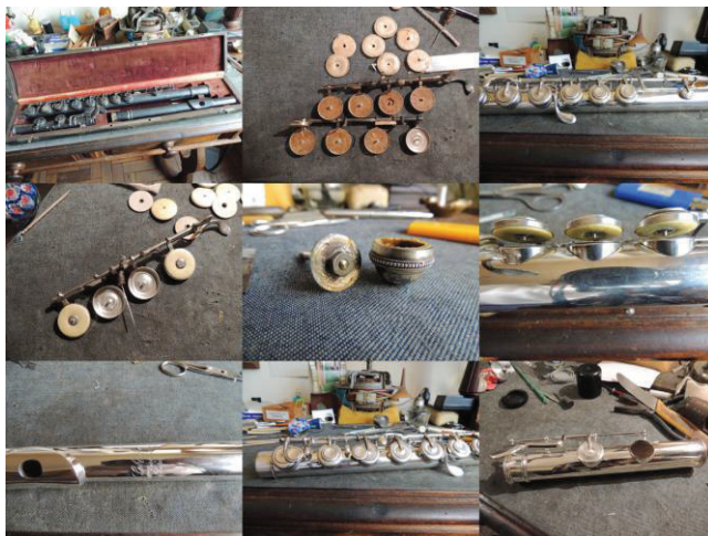
Figura 2: Processo de restauração da flauta Lébret Fonte: fotos de Franklin Correa da Silva Neto
