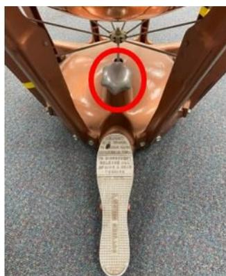
**Figura 52:** Peça de ajuste da tensão da mola.
