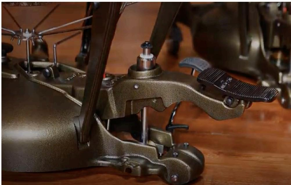
**Figura 61:** Pedal com sistema de embreagem de fricção.
