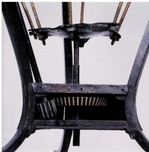
**Figura 26:** Mecanismo de afinação utilizado no protótipo exposto na *Galleria dell'Accademia* (Montagu, 2002, p. 125).
