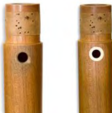
Figura 26: Orifício do polegar desgastado pelo uso (à esquerda) e restaurado pela Mollenhauer (à direita), com a inserção de um anel feito de marfim artificial. Imagem disponível em: < https://www.mollenhauer.com/en/service/recorder-clinic >
