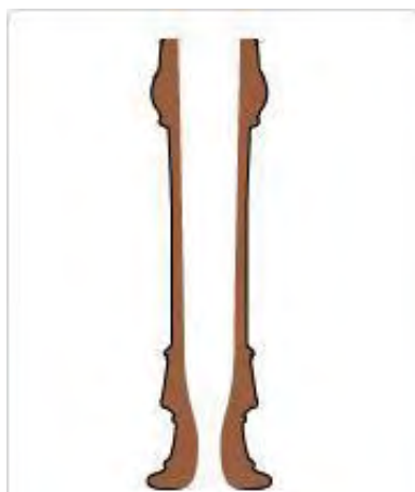
Figura 4: Formato interno do tubo de uma flauta doce convencional. Fonte: Yamaha. Disponível em: < https://www.yamaha.com/en/musical_instrument_guide/recorder/mechanism/mechanism002.html >
