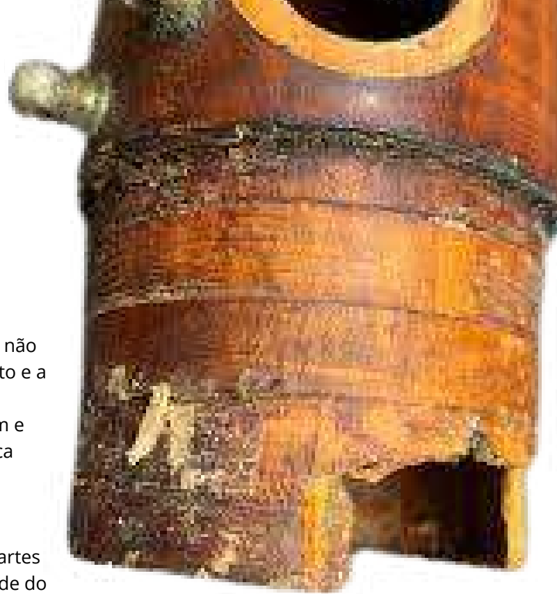
Essa imagem mostra uma das consequências do manuseio incorreto do instrumento, tanto por impacto quanto por má secagem
