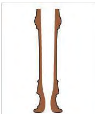
Figura 4: Formato interno do tubo de uma flauta doce convencional. Fonte: Yamaha. Disponível em: < https://www.yamaha.com/en/musical_instrument_guide/recorder/mechanism/mechanism002.html >
